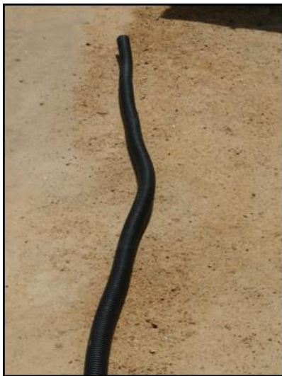
Figura 30 – Tubo PVC corrugado utilizado na drenagem.
